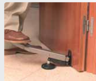
Pour le levage et la mise en place de portes lourdes.
