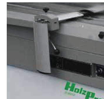
Pont de protection escamotable
